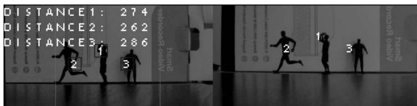
Рисунок 16. Поиск объектов и расчет расстояния. Изображение из OpenMV IDE
