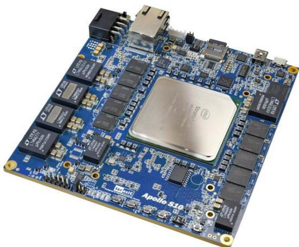
Рисунок 5. FPGA-плата Stratix-10
